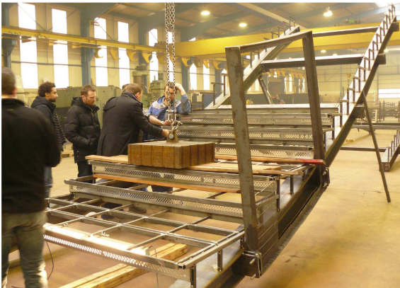
Montage à blanc et essai à l'atelier
