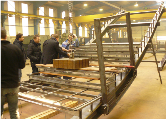
Montage à blanc et essai à l'atelier
