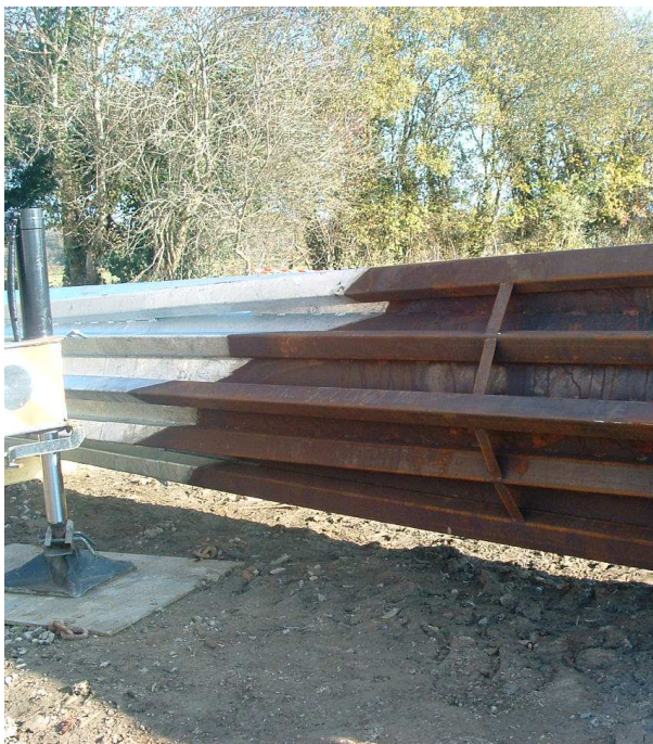
Limite de galvanisation naturellement obtenue par la trempe partielle de la pièce
