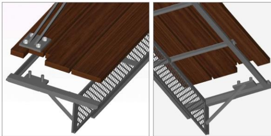
Détail de fixation de la main courante
