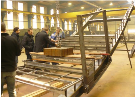
Montage à blanc et essai à l'atelier
