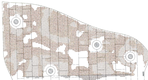
Image Architecte et plan de calepinage des panneaux avec cartographie des pavés de verre
